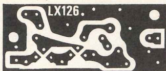
Fig. 3 Sulla sinistra il circuito stampato a grandezza naturale, sulla destra le connessioni dei terminali del fet e del transistor 2N709.
